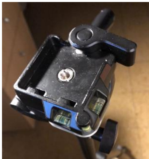
Vista frontale della femmina Notare le 3 piccole bolle (una per ogni direzione) per verificare l'allineamento
