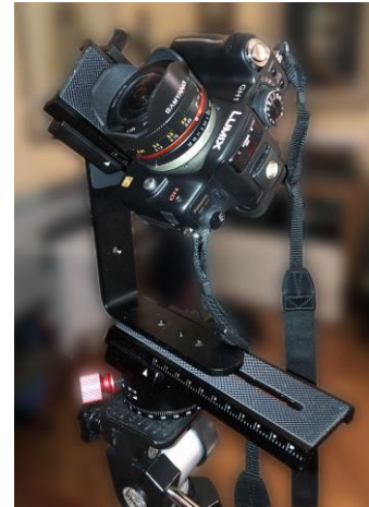
La mia testa panoramica in uno dei primi esperimenti (in questa foto c'è ancora la Lumix GH1, ora convertita all'infrarosso)
