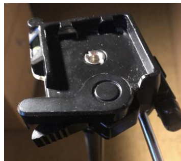
Vista laterale della femmina La fotocamera è fissata con la grossa leva a scatto sul retro della flangia
